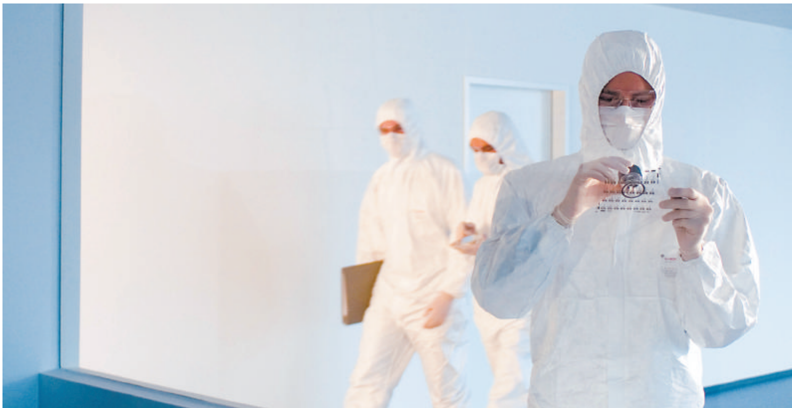
Halbleitersensoren werden unter Reinstraumbedingungen gedruckt. Ein Kubikmeter Linzer Luft etwa weist zehn Milliarden Partikel auf. Im Reinraum der Klasse 100 befinden sich nur 3500 Partikel pro Kubikmeter, die kleiner als 0,05 Millimeter sind. Foto: Nanoident
