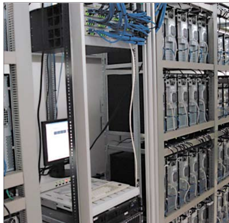
240 Prozessoren sind in der Fakultät für Physik der Uni Wien zu einem Hochleistungsrechner verbunden. Foto: Fakultät für Physik
